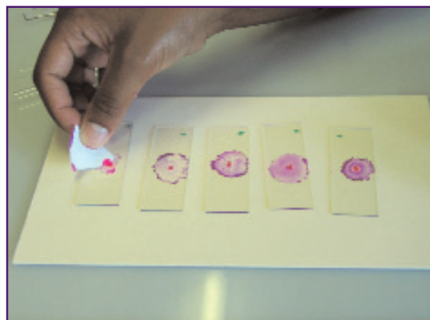
Aspecto do método de coloração: Amostra 5: coloração rosa = óleos. Amostra 6: coloração rosa intenso = resinas.
